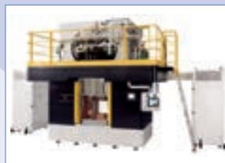
自動車駆動系部品向け大型溶接機
