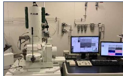
走査電子顕微鏡 (JSM-7100F)
